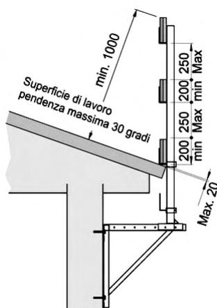
Rispondono ai requisiti della UNI EN13374 allegato B classe B. Coperture aventi max 30° di pendenza (58%) oppure max 60° se l'altezza di caduta è inferiore a 2m.
