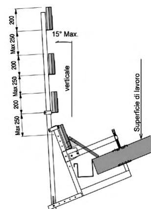
**SISTEMA PER IMPIEGO SU COPERTURE IN LEGNO** Questo sistema è realizzato in acciaio zincato e tavole legno d'abete. Interasse 1,4m. Spessore delle travi da 100 a 160 mm. Con leva di sblocco per lo smontaggio rapido.
