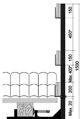
**SISTEMA COMPLEMENTARE PER IMPIEGO LATERALE (CLASSE A) SU COPERTURE IN LEGNO.** Questo sistema è realizzato in acciaio zincato e tavole legno d'abete. Interasse 1,4m. Spessore delle travi da 100 a 150mm. Con leva di sblocco per lo smontaggio rapido.
