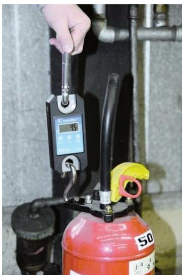
Un comodo dinamometro elettronico che include ganci per misurare piccoli pesi, rapidamente e facilmente.
