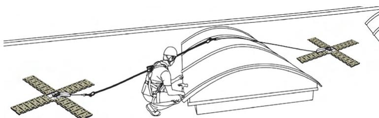
I lavori di installazione e manutenzione di lucernari su tetti a shed piani o leggermente inclinati comportano situazioni di rischio di esposizione dell'operatore con effetto pendolo e elevate distanze di arresto, anche all'interno del perimetro della linea di grondaia. Nell'illustrazione viene mostrata, attraverso l'utilizzo combinato di due dispositivi anticaduta Blocfor collegati a due punti di ancoraggio Mobifor, una procedura che permette di ridurre le distanze di intervento.
