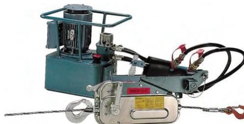
I paranchi **Tirfor TU-H** a fune passante sono azionati da un pistone idraulico utilizzando una alimentazione elettrica o con motore termico a benzina.
