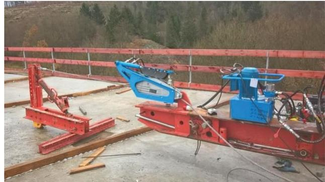
Il Tirfor TU-A16 e TU-A32 sono motorizzati da un sistema pneumatico alimentato da un sistema di aria compressa. È comunque possibile l'azionamento manuale.
